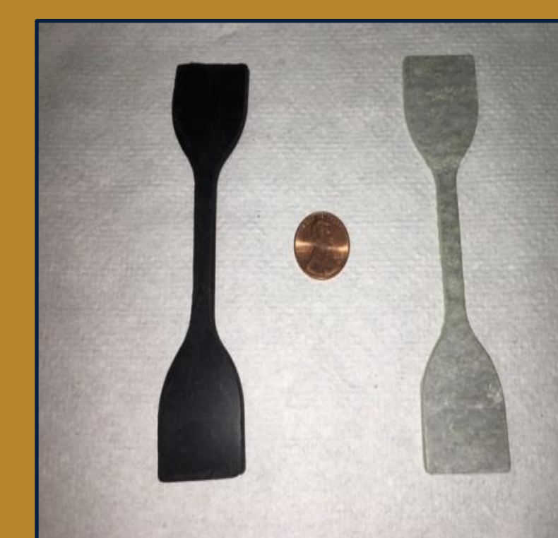
EPDM & Garlock® ASTM D412-C dumbbell coupons
